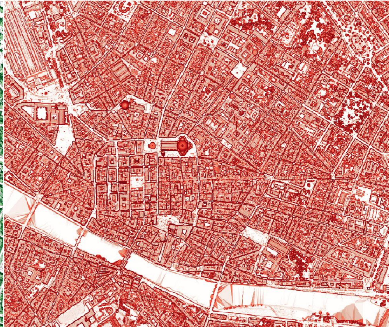
TETTI: angolo di inclinazione
